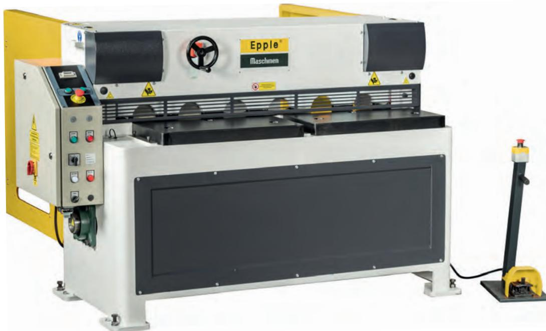
Cisaille guillotine motorisée pour des épaisseurs de matériaux jusqu'à 3 mm pour la découpe de métaux et autres matériaux sous formes de plaques. Le moteur, le système de freinage avec le système de refroidissement, ainsi que la cloche d'embrayage permettent un fonctionnement silencieux et la consommation d'énergie a été réduite au minimum.
